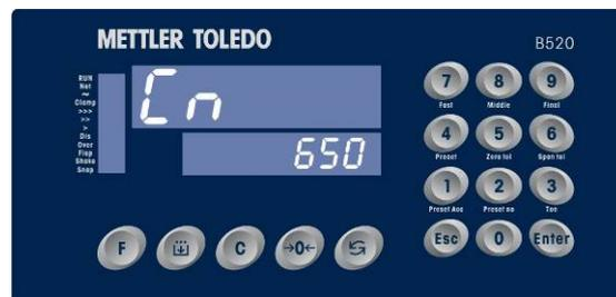
当总包数到达 650 包时。控制器将会自动停止包装程序，下行显示“END”
