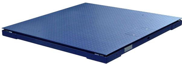
SCS 秤体采用优质U型梁和花纹钢板，表面环保油漆喷塑工艺能够适应各种复杂的工业环境，采用SBTL合金钢材质传感器防护等级可达IP67，摇柱式结构传感器确保地磅长期的稳定和准确
