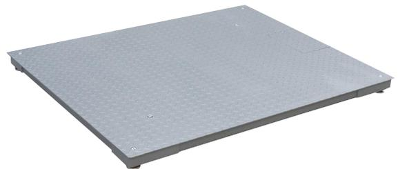
SCS 秤体采用优质304不锈钢材料密封焊接工艺，特殊的表面处理能够适应各种复杂的工业环境，采用SBS不锈钢材质传感器防护等级可达IP68，摇柱式结构传感器确保地磅长期的稳定和准确。
